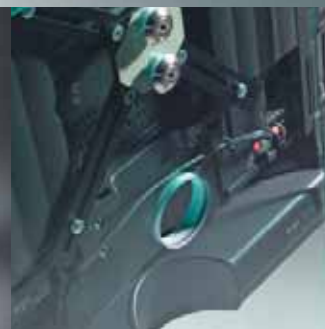
Отверстие для прокладки кабеля
