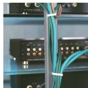
Для соединения проводов пользуйтесь фиксаторами.
