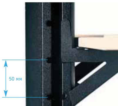
Полки можно передвигать по стойке с шагом 50 мм. Стопорный штифт надежно фиксирует их положение.
