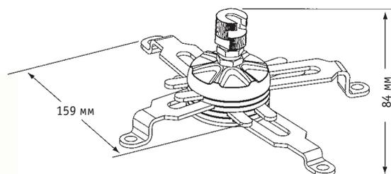
Проектор закрепляется в перевернутом положении (ножками вверх). Собранный крепеж фиксируется на проекторе при помощи болтов различной длины и диаметра, вкручивающихся в заводские отверстия.
